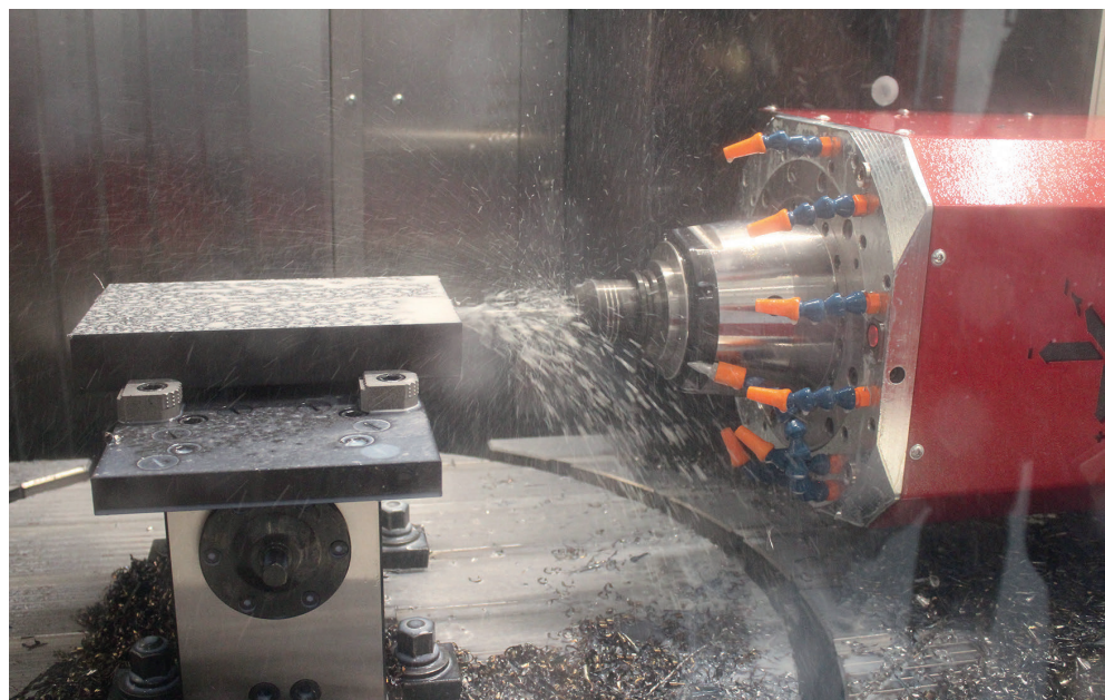
1 Ob IKZ oder Überflutungskühlung: Die schaumarmen Kühlschmierstoffe von Oest harmonisieren perfekt mit den Bearbeitungszentren von Hedelius © Oest
